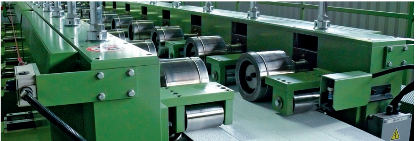
Początek produkcji paneli - kształtowanie blachy
